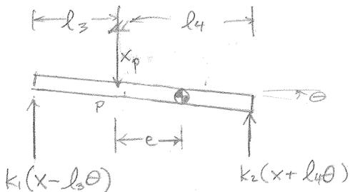
$$\begin{bmatrix} m & me \\ me & J_p \end{bmatrix} \begin{Bmatrix} \ddot{x}_p \\ \ddot{\theta} \end{Bmatrix} + \begin{bmatrix} k_1+k_2 & 0 \\ 0 & k_2 l_4^2 + k_1 l_3^2 \end{bmatrix} \begin{Bmatrix} x_p \\ \theta \end{Bmatrix} = \begin{Bmatrix} 0 \\ 0 \end{Bmatrix} \quad (3)$$
